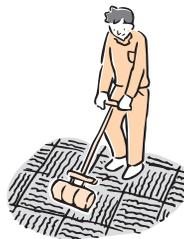
塗布量が少ない時や、ローラー圧着が少ないと、ふくれや浮き上がりが生じる恐れがありますので、必ず手順に従って施工してください。
